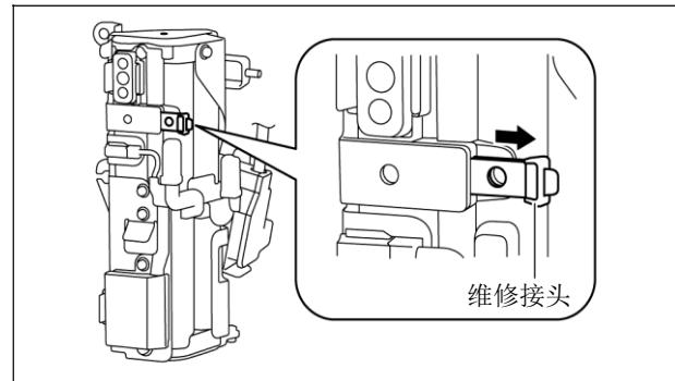
10. 使用取下的安装螺栓，将维修接头固定在它被拉出的位置。
