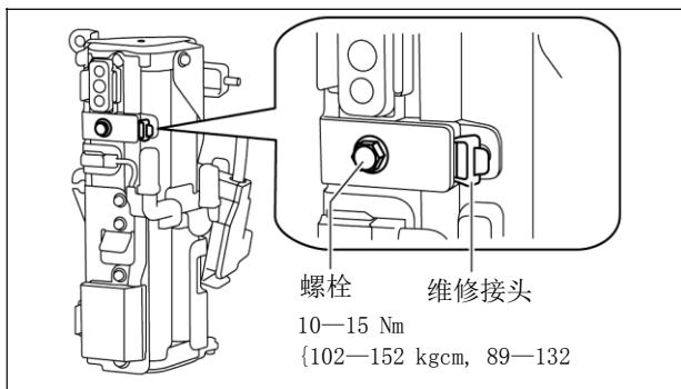
9. 按箭头方向拉出维修接头如图所示。
