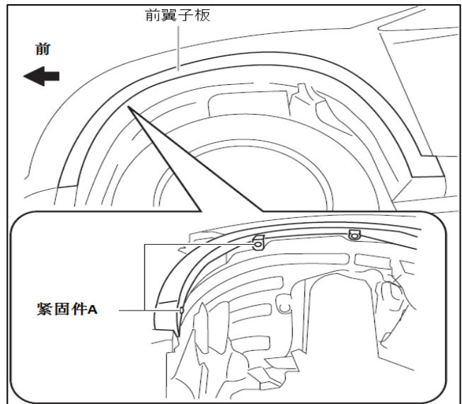
4. 将前翼子板盖向箭头指示方向拉，拆下卡箍A。
