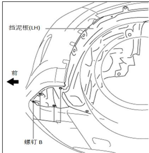
7. 将前挡泥板 (LH) 取下如图所示。
