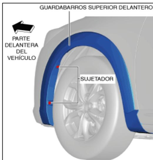
4. Mover la herramienta extractora en la dirección de la flecha que se muestra en la figura y desenganchar las grapas del guardabarros superior delantero (lado izquierdo) en 5 ubicaciones del parachoques delantero.
