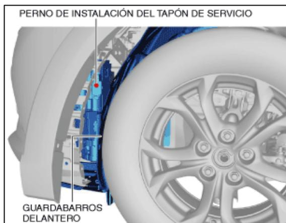
7. Quitar el perno de instalación del tapón de servicio que se muestra en la figura.
