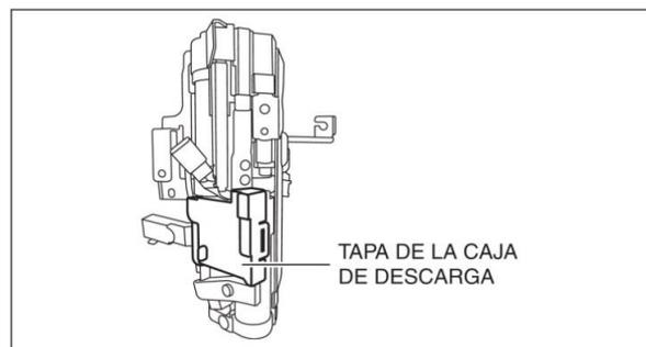
11. Conectar el conector de la caja de descarga al tapón.
