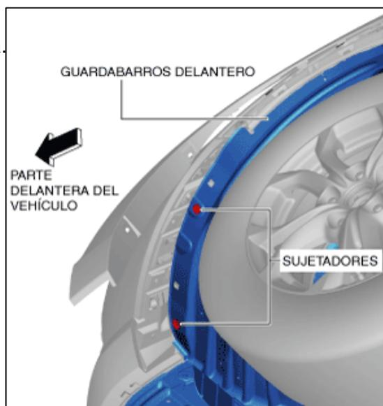
6. Colocar el guardabarros delantero (lado izquierdo) a un lado para obtener acceso al perno de instalación del tapón de servicio.
