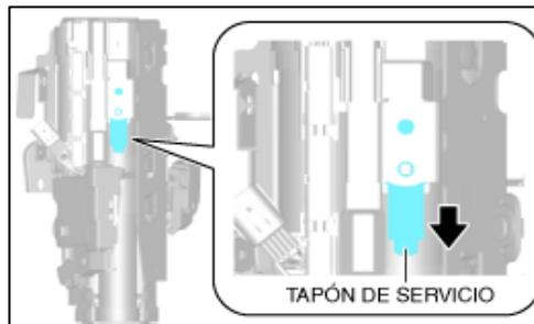
9. Con el perno de instalación extraído, colocar temporalmente el tapón de servicio en la posición en la que se ha extraído.
