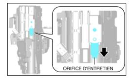
À l'aide du boulon de repose déposé, maintenir temporairement la prise de service à la position à partir de laquelle elle a été retiré.
