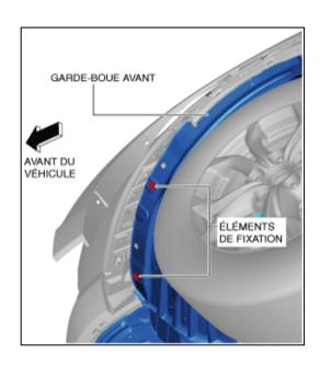
6. Mettre de côté le garde-boue avant (gauche) pour permettre d'accéder au boulon de repose de la prise de service.
