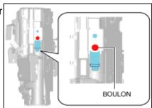
10. Déposer le couvercle du boîtier de décharge.
