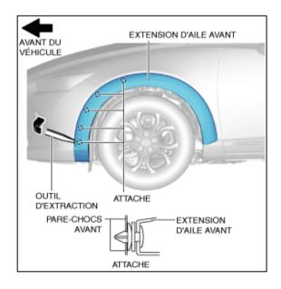
5. Déposer les 2 éléments de fixation du garde-boue avant (gauche) indiqués sur l'illustration.
