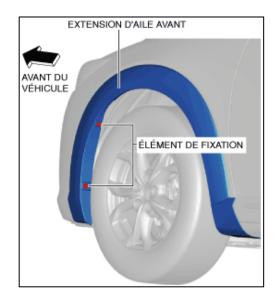
4. Déplacer l'outil de dépose dans le sens de la flèche indiquée sur l'illustration, puis dégager les attaches d'extension d'aile avant (gauche) des cinq emplacements du pare-chocs avant.
