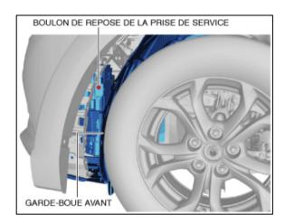
7. Déposer le boulon de repose du de l'orifice d'entretien comme indiqué sur l'illustration.
