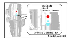
8. Tirer l'orifice d'entretien dans le sens de la flèche indiquée sur l'illustration.
