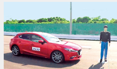
歩行者対応自動ブレーキ試験の様子 (写真提供: NASVA)
