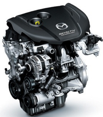
図1 低圧縮比クリーンディーゼルエンジンの外観
